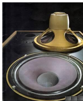
左はスピーカーシステム(ボックス)をバラした状態 単体のスピーカーに見えるが、スピーカーの奥(コーン紙の中)に高音用のホーン型スピーカーを内蔵している。
